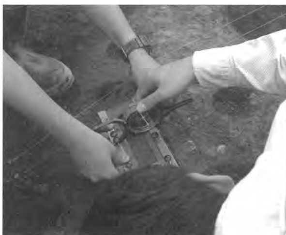
写真3 傾斜角を測定する 走向角と傾斜角は測定時に使用する
