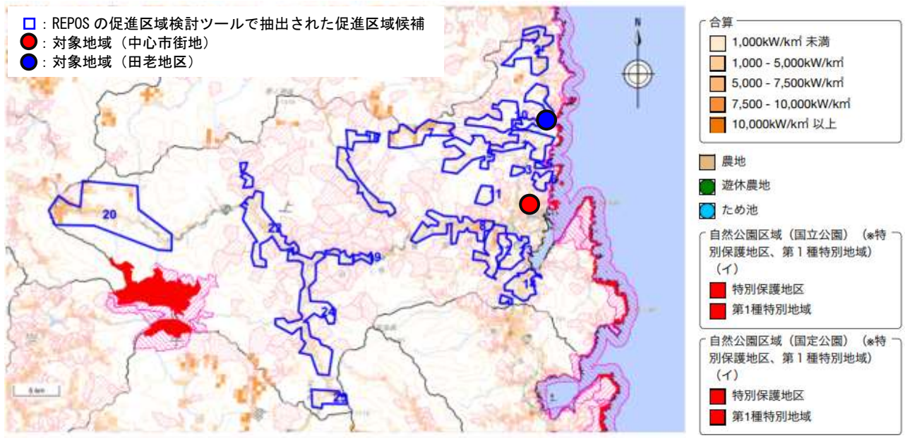
太陽光発電（土地系）のポテンシャルマップ（REPOS の促進区域検討支援ツール引用）
