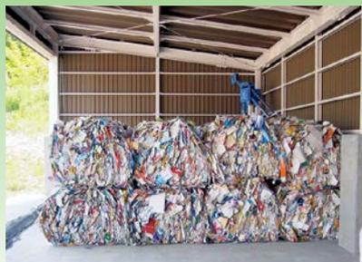
集められたものは、手選別によって異物が除去され、ボール（1㎡に圧縮された塊）になって、リサイクル事業者に引き渡されます。ボールは製紙原料となり、「グリーンマーク」が表示された紙製品などに生まれ変わります。
