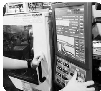
プラスチック射出成形機を操作し加工条件設定する工程
