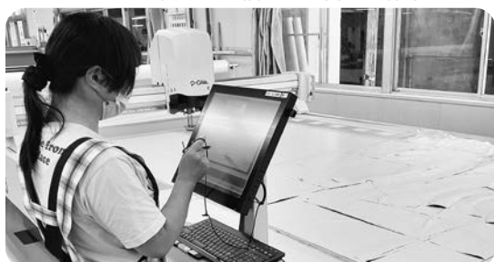
自動裁断機を操作し、型紙通りに裁断する工程
