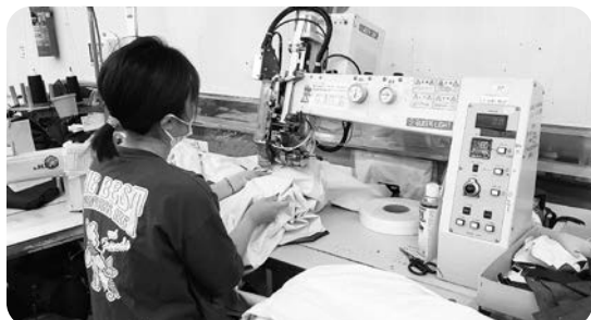
水漏れ防止のため、縫い目に防水テープを貼る工程
