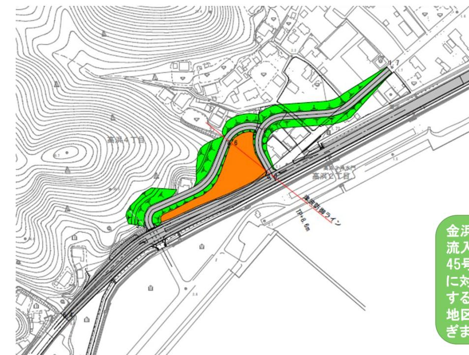
金浜方面からの津波の流入を防ぐために国道45号を嵩上げし、それに対して市道も嵩上げすることによって、高浜地区への津波被害を防ぎます。
