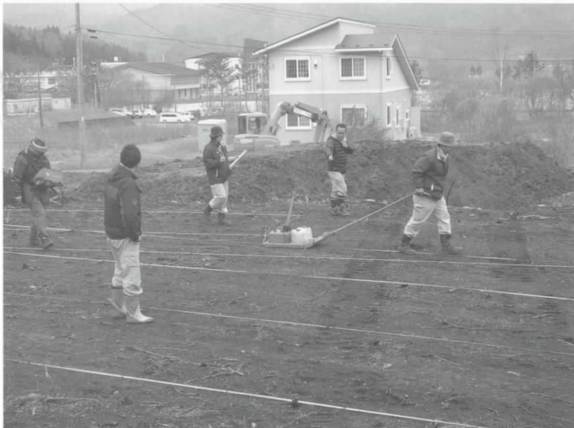
6. 地中レーダー探査 実験状況（東→）
